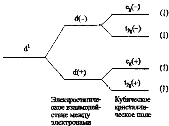
Рис. 1.10. Расщепление уровней d-оболочки за счет внутриатомного электростатического взаимодействия между электронами и действия кубического кристаллического поля средней силы (знаками «+» и «-» отмечены противоположные ориентации спинов)
