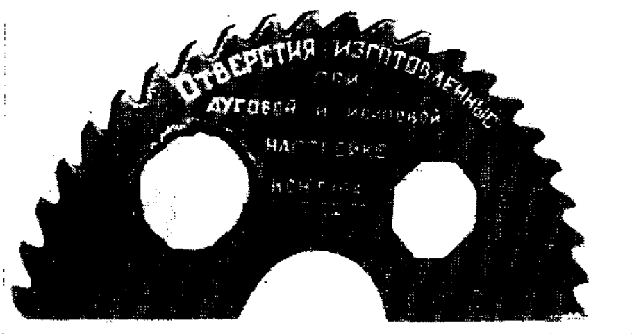
Рис. 242. Отверстия, изготовленные с использованием дугового (слева) и искрового (справа) разрядов.
