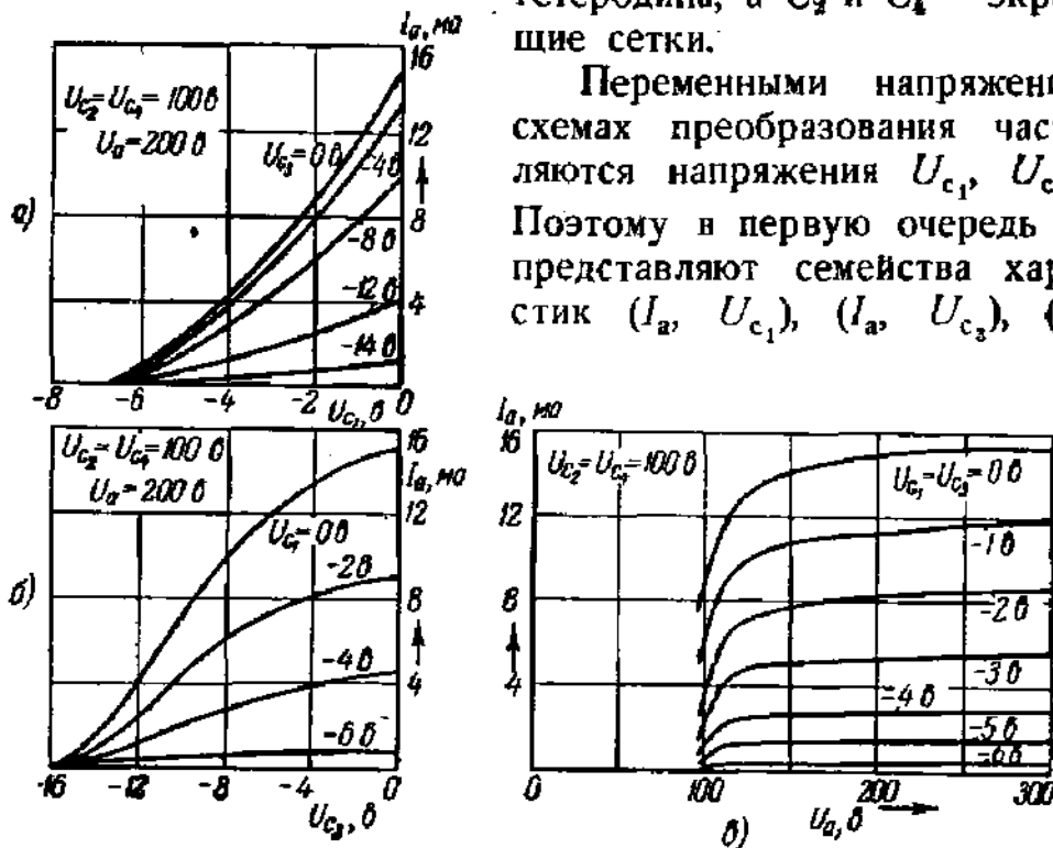
Рис. 388. Характеристики гексода с неразделенным электронным потоком.
