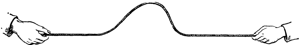
Рис. 166. Поперечная волна, бегущая по резиновому жгуту.
