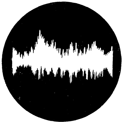
Рис. 416. Наблюдение шума радиоприемника с помощью электронного осциллографа.
