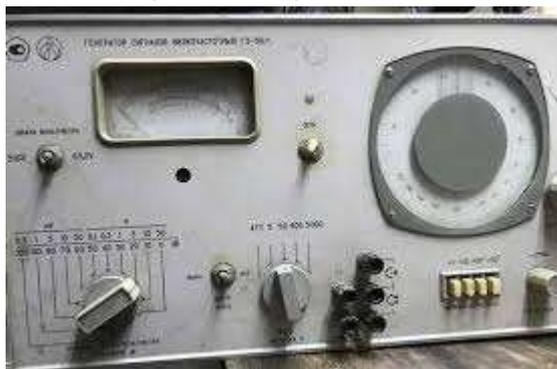
Генератор сигналов низкочастотный ГЗ-56/1 используется при регулировке и испытании каскадов радиоаппаратуры в лабораторных и цеховых условиях.
