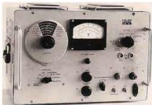
**Генератор ГЗ-7А** - измерительный прибор, используемый для испытания и настройки различных широкополосных систем видеочастоты, проверки и настройки видеоусилителей различной радиотехнической аппаратуры.
