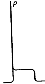
Рис. 172. Форма импульса просачивающейся в приёмник мощности. P —пик просачивающейся мощности.
