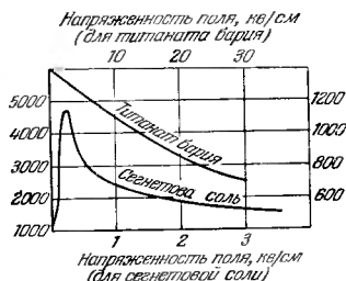
Рис. 40. Зависимость диэлектрической проницаемости титаната бария (шкала справа) и сегнетовой соли (шкала слева) от напряженности поля (при 20^\circ C ).
