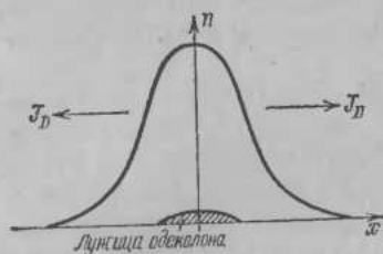
Рис. 22. Распределение молекул одеколона над пролитой лужицей: в области x > 0 производная dn/dx < 0 ( n уменьшается с ростом x ), диффузионный поток носителей J_D > 0 (направлен вдоль положительного направления оси x ); в области x < 0 производная dn/dx > 0 , диффузионный поток J_D < 0
