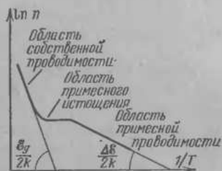
Рис. 5. Зависимость логарифма концентрации электронов от обратной температуры
