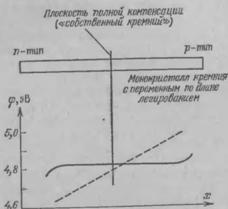
Рис. 34. Зависимость работы выхода от координаты в монокристалле кремния с переменным по длине легированием: штриховая прямая — расчетная зависимость; сплошная кривая — зависимость, измеренная экспериментально в высоком вакууме послойным скалыванием кристалла (эксперимент Аллена и Гобели, 1962 г.)
