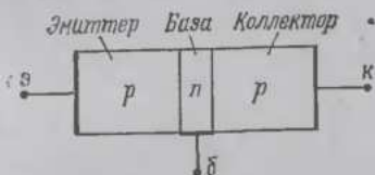
Рис. 98. Структура биполярного p-n-p транзистора
