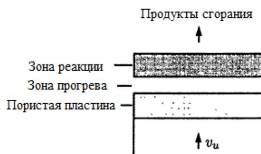
Рис. 6. Структура плоского ламинарного пламени
