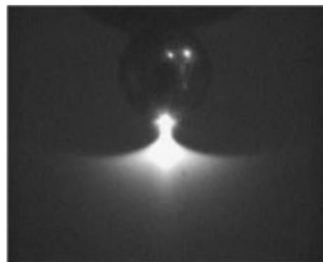
Рисунок 12. Фото чехла отрицательного коронного разряда у поверхности шарового электрода
