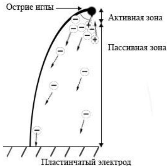
Рисунок 1. Движение ионов при коронном разряде
