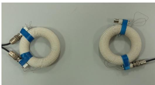
(а) Две использовавшихся катушки ( $p = 3, q = 46$ ) с подключенными к приборам, вид сверху.
