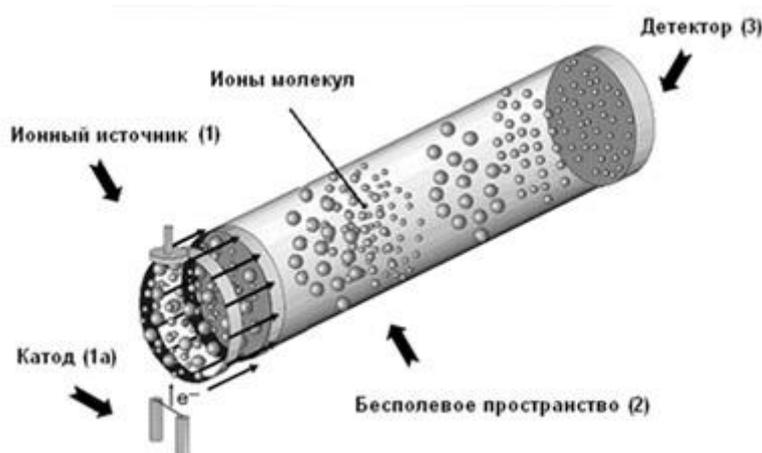
Рис. 1. Общая схема времяпролетного масс-спектрометра.
