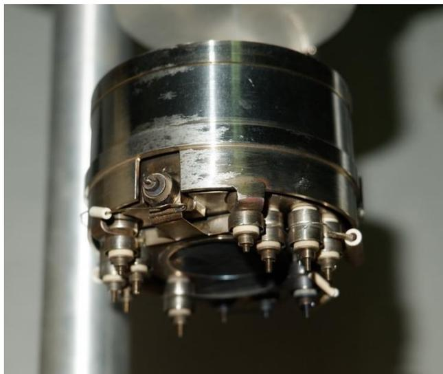
Рис.3. Ионный источник, используемый в данной работе.
