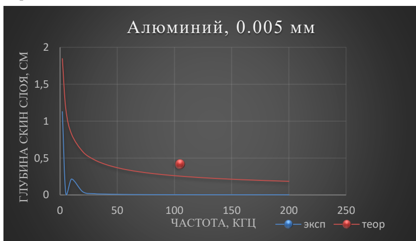
Рис.7. Зависимость теоретической и экспериментальной глубины скин-слоя от частоты электромагнитной волны. В алюминиевой пластине толщиной 0.005 мм
