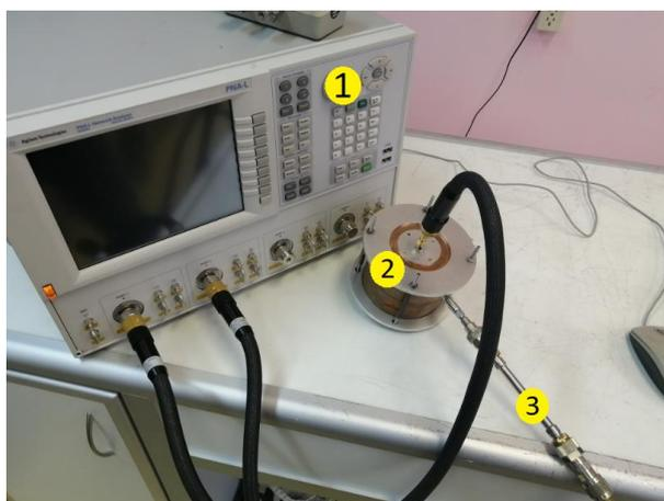
Рисунок 5 измерителя S – параметров цепей с подключенным резонатором и СВЧ фильтром. 1 - Анализатор цепей PNA-L Network Analyzer. 2 - Резонатор. 3 - СВЧ фильтр для подавления высоких частот
