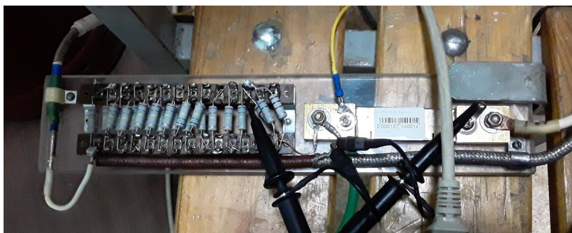
Рис. 4. Шунты, подключённые к источнику
