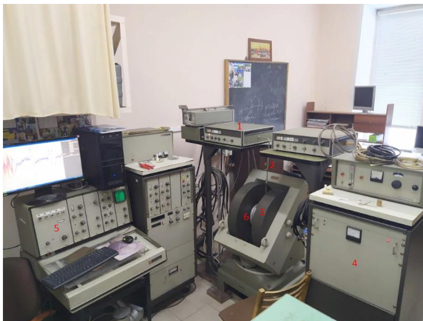
Рис. 2 Общий вид спектрометра Varian E109: 1 – блок генератора СВЧ; 2 – волноводный тракт; 3 – электромагнит; 4 – блок питания; 5 – управления спектрометром; 6 – резонатор
