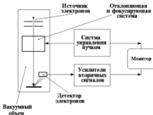
Рис. 3 Примерная схема устройства СЭМ
