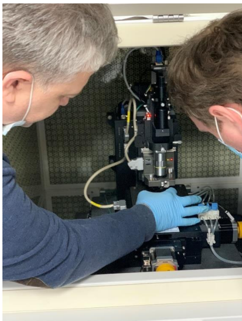
Рис. 6. Закрепление образца в камеру атомного силового микроскопа
