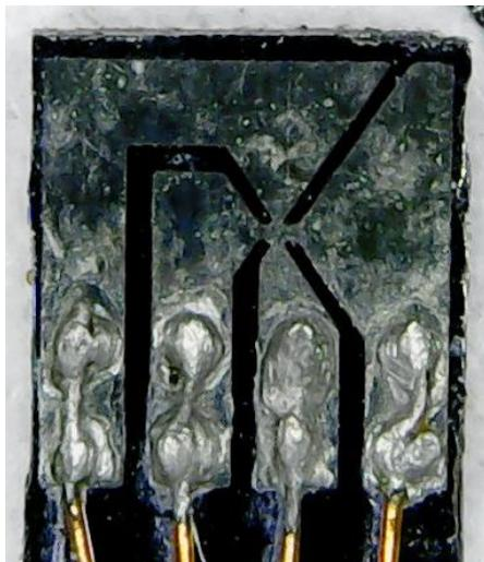
*Рис.3. Датчик Холла типа ПХЭ 603118Б.*
