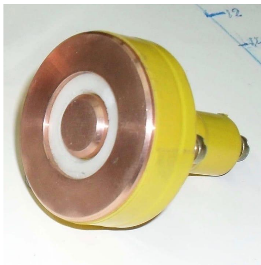
Рис. 6. Фотография круглого щупа, которым измеряется сопротивление электродов
