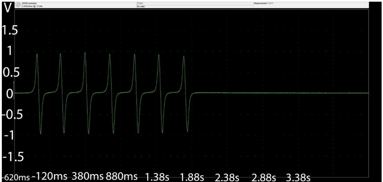
Рис. 10. Осциллограмма сигнала для латунной трубки
