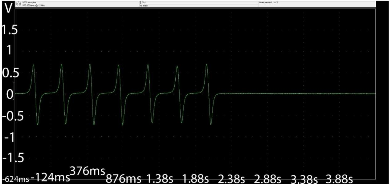
Рис. 8. Осциллограмма сигнала для алюминиевой трубки с продольным разрезом
