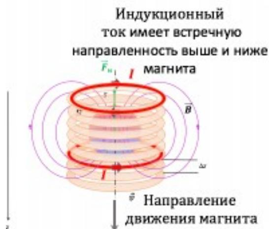
рис. 2 Магнит в проводящей трубке
