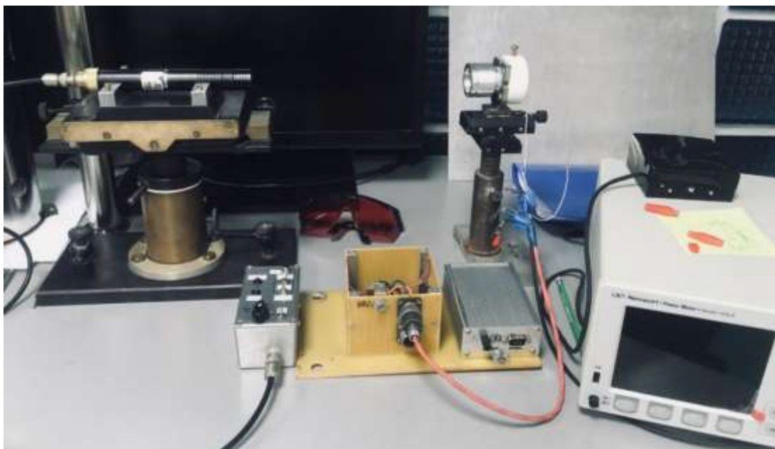
Рисунок 4. Установка для калибровки болометров.
