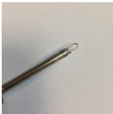
Поляризация магнитного поля в волноводе измерялась с помощью индукционного датчика, изображённого на Рис.2, вводимого в отверстие в волноводном тракте, и представляющего собой металлическую петлю. Так как поле переменное во времени, поток, проходящий через площадь, ограниченную петлёй, изменяется, что по закону Фарадея приводит к возникновению переменной ЭДС и тока, который по коаксиалу подавался на анализатор цепей.
