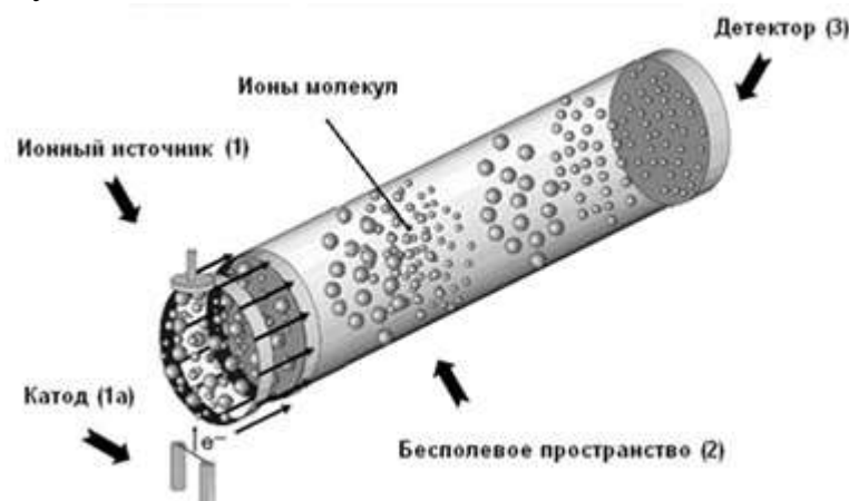
Рис. 2. Схема разделения ионов на пучки в трубе дрейфа
