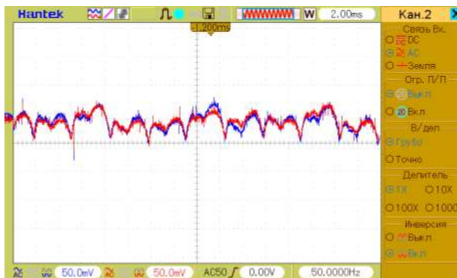
Рис. 8. Осциллограммы тока, возникающего в двух каналах источника питания при максимальном подавлении пульсаций тока разряда.
