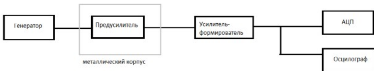
Рис 9: Схема установки. Сигнал амплитудой от 1 до 100 мВ подаётся с генератора на предусилитель, после чего сигнал идёт в усилитель-формирователь (в нашем случае это либо Naicam DCB215 DCB215, либо Ortec 570), после чего сигнал уходит в АЦП, а его изображение выводится на осциллографе. В эксперименте металлический корпус играет роль экрана от внешних воздействий
