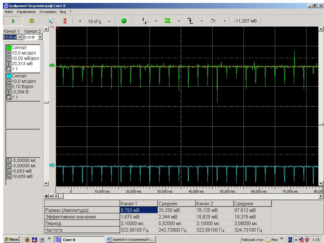
Рис.3. Осциллограмма импульсов отраженной (зелёный цвет) и прямой (голубой цвет) волн при настроенном резонаторе.
