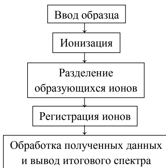
Рис. 1. – Схема работы масс-спектрометра.
