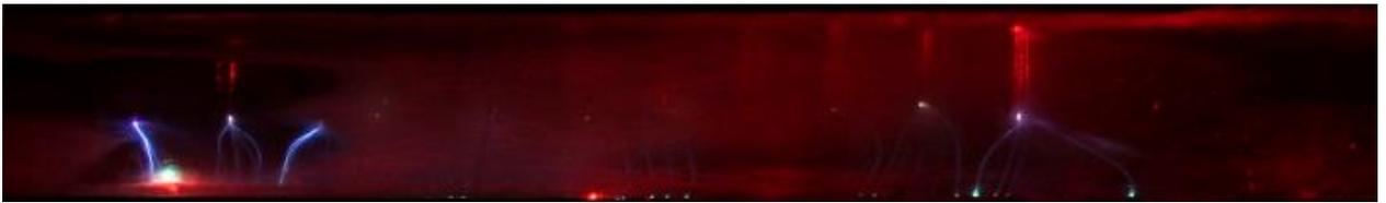
Рис. 8. Явление пробоя в пробоотборнике при горении твердотопливного состава с  $AlB_{12}$
