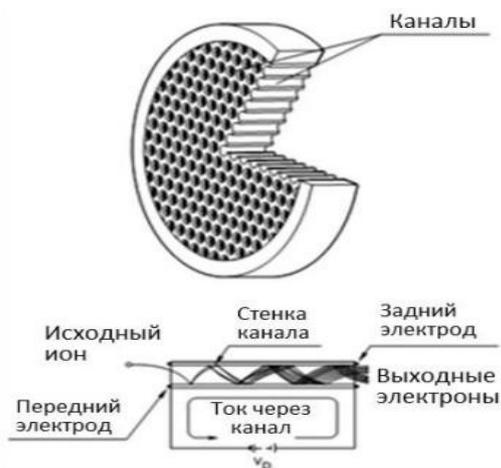
Рисунок 4. Схема и принцип работы микроканальной пластины. Заимствованно на сайте Hamamatsu [3].
