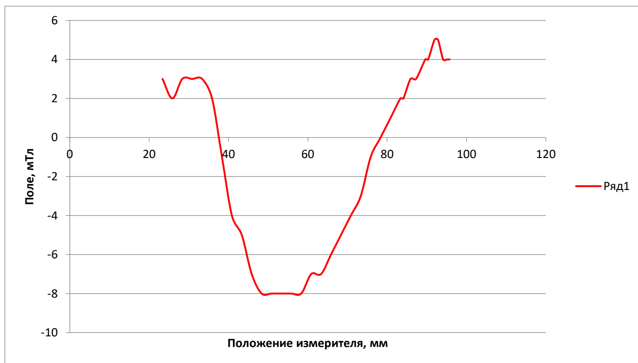
Рис.12 Измерение поперечной компоненты магнитного поля.
