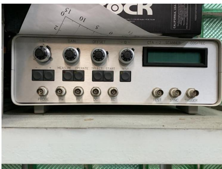
Рис. 1. Термоанемометр в лаборатории №14 ИТПМ СО РАН «Волновых процессов в сверхзвуковых течениях»
