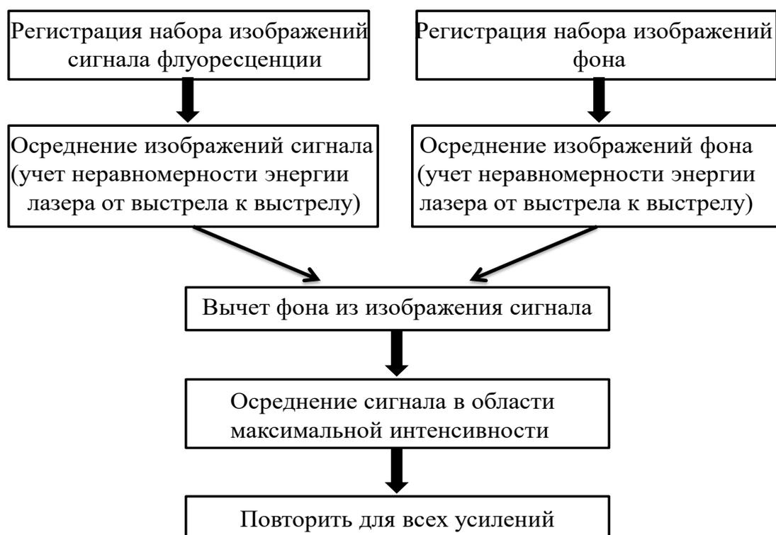
Рис. 8. Блок-схема программы регистрации и обработки экспериментальных данных
