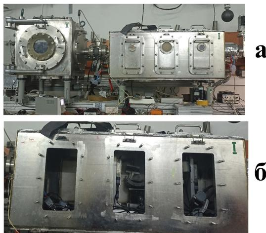
Рис. 7. Фото станции. Буквами обозначены состояния: а) закрытые фланцы; б) открытые фланцы
