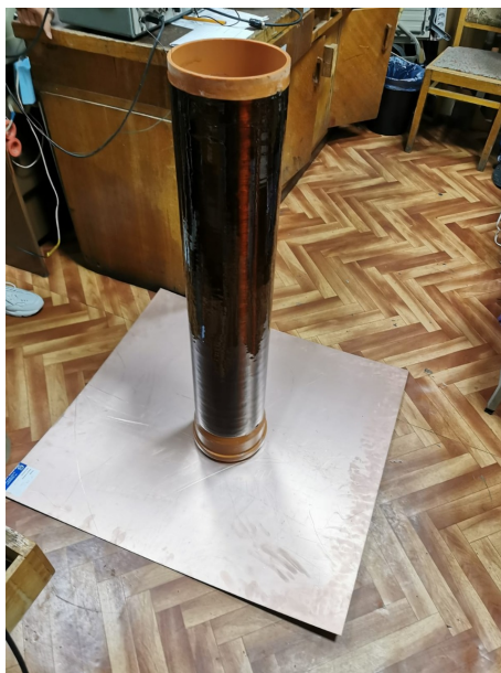
Рис. 9. Постановка эксперимента по определению полуволновой резонансной частоты
