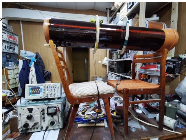
Рис. 8. Определение четвертьволновой резонансной частоты
