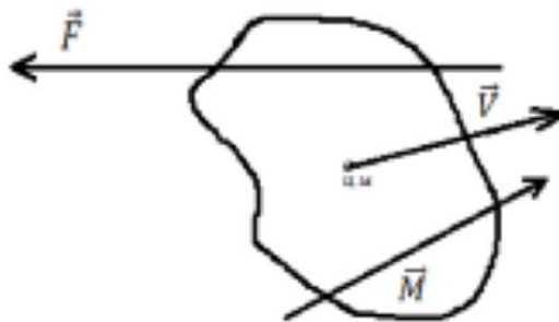
Рис. 1. Составляющие аэродинамических сил и моментов для тела произвольной формы
