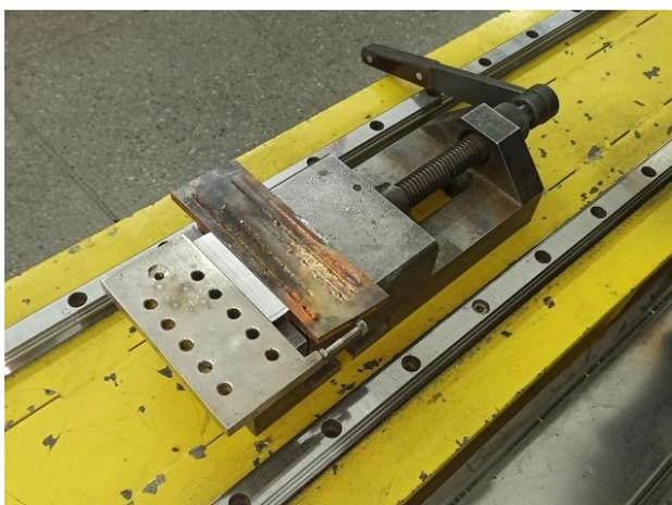
Рисунок 7. Закрепленные образцы на подставке
