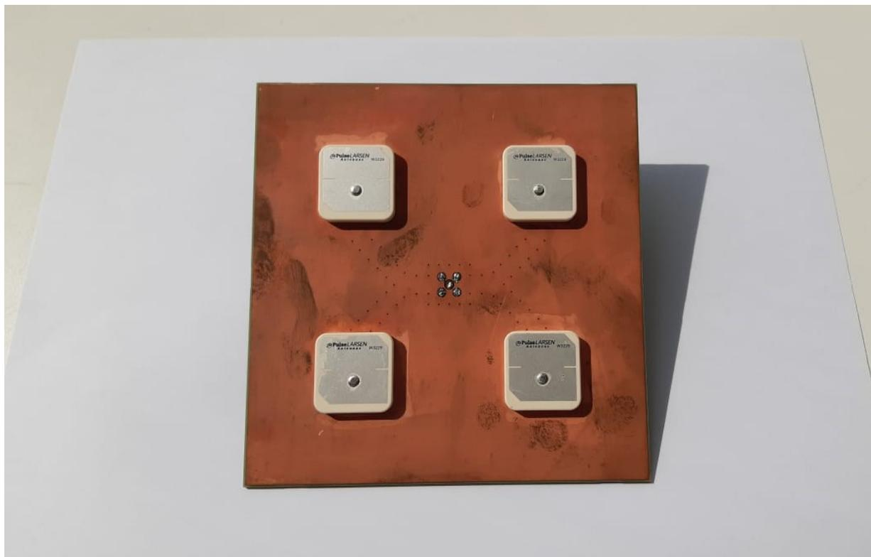
*Рис. 12. Прототип стека антенн для СмКА «Норби-2»*
