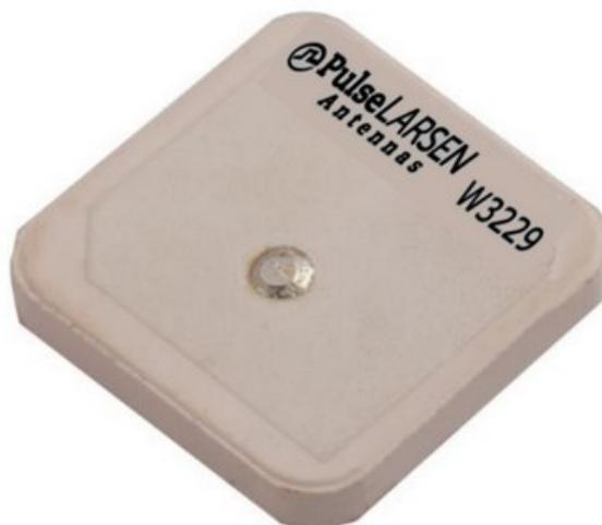
*Рис.6. Патч-антенны с обрезанными противоположными углами пластины вибратора, частота 2,4-2,5 ГГц, правая круговая поляризация, размер 25x25x4 мм, коэффициент усиления 6.5 дБи*
