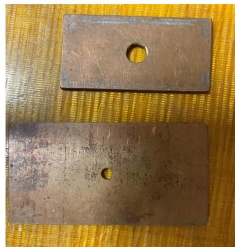
Рис. 6 Диафрагмы входа и выхода
