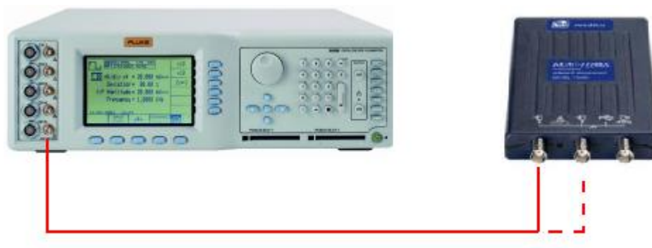
Рисунок 2 – Схема подключения приборов при поверке
