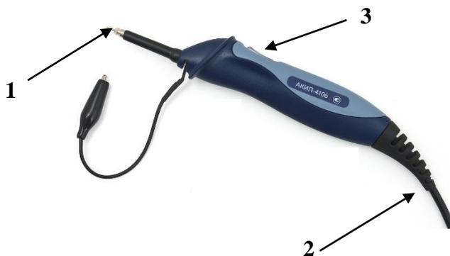
1. Щуп-пробник измерительный (со встроенным светодиодом подсветки)
